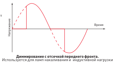
Рис. 6. Выбор фронта отсечки сетевого напряжения
