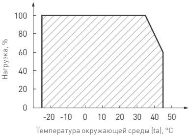
Рис. 3. Максимальная допустимая нагрузка, % от мощности источника
