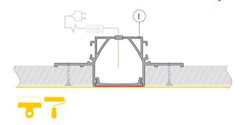
4 / После полного высыхания и обработки слоя шпаклевки удалите малярный скотч с экрана (II). Снимите экран (II). Удалите остатки шпаклевки из профиля (). Очистите внутреннюю часть профиля () от излишков шпаклевки, краски и пыли. Обезжирьте поверхность профиля перед установкой ленты.
