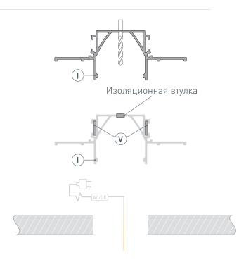
2 Проведите кабель питания светодиодной ленты через изоляционную втулку в профиле (). ВНИМАНИЕ! Для защиты от загрязнения поверхности профиля, а также для исключения вероятности изменения конструктива профиля, при проведении отделочных работ перед установкой профиля в гипсокартон ОБЯЗАТЕЛЬНО установите на профиль () экран (I) и заклейте его малярным скотчем. Установите на профиль () заглушки (II). Вставьте профиль () в подготовленный проем и зафиксируйте его в нем.
