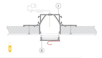
5 / Установите светодиодную ленту (IV) в профиль (1). Подключите светодиодную ленту (IV), строго соблюдая полярность, обозначенную на плате.
