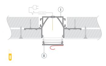
Установите светодиодную ленту (V) в профиль (). Подключите светодиодную ленту (V), строго соблюдая полярность, обозначенную на плате.
