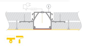
5 / После полного высыхания и обработки слоя шпаклевки удалите малярный скотч с экрана (I). Снимите экран (I). Удалите остатки шпаклевки из профиля (). Очистите внутреннюю часть профиля () от излишков шпаклевки, краски и пыли. Обезжирьте поверхность профиля перед установкой ленты.
