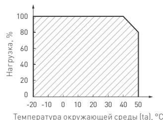
Рис. 2. Максимальная допустимая нагрузка, % от мощности источника
