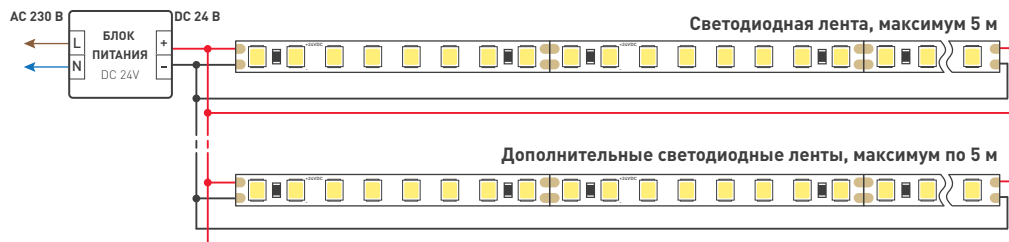
Схема 1. Подключение нескольких светодиодных лент с двух сторон
