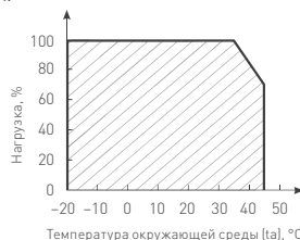
Рисунок 4. Максимальная допустимая нагрузка, % от мощности источника
